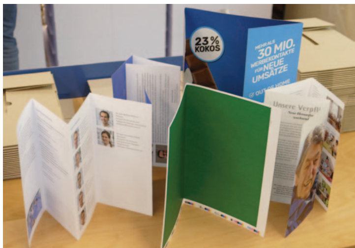
Alles in einem Durchgang produziert: Verschiedene Rill-, Nut-, Perforier- und Falzarten sind bei Scheufele schnell hintereinander produzierbar.
